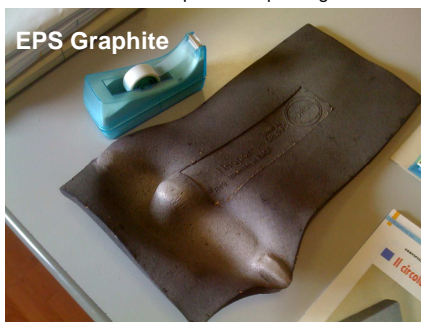
deformazione esposizione prolungata U.V.
